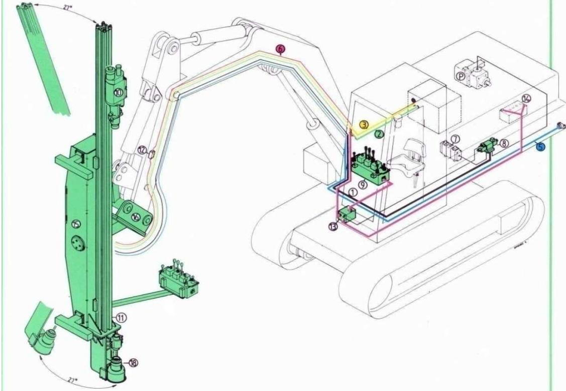
**Todos los componentes hidráulicos y controles están incluidos dentro de la CPA para tener una fácil adaptación y una utilización autónoma**
