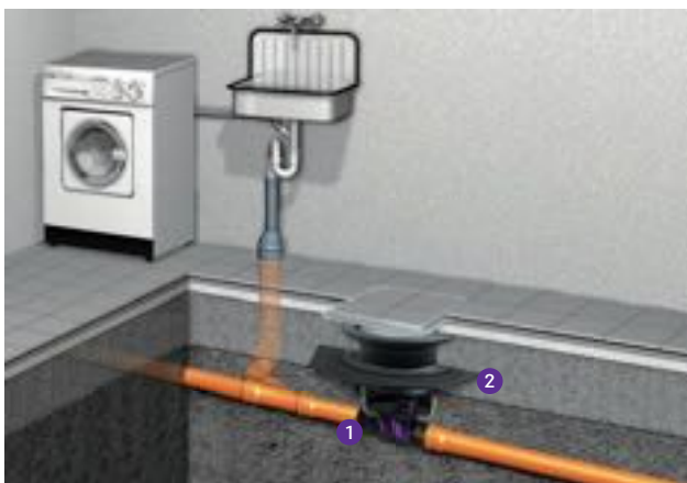
1 Válvula antirretorno 2 Sección de extensión
