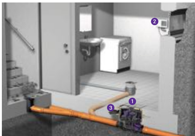
1 Estación de bombeo antirretorno 2 Unidad de control 3 Juego de juntas de sellado
